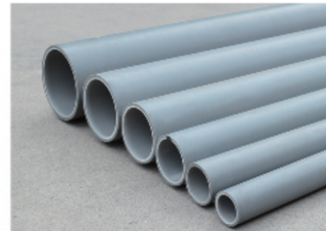
挤塑成型A管 4米/支 颜色：米黄/深灰 PP材质： \phi 20 \sim \phi 90 \text{mm} PP阻燃材质： \phi 40 \sim \phi 90 \text{mm}
