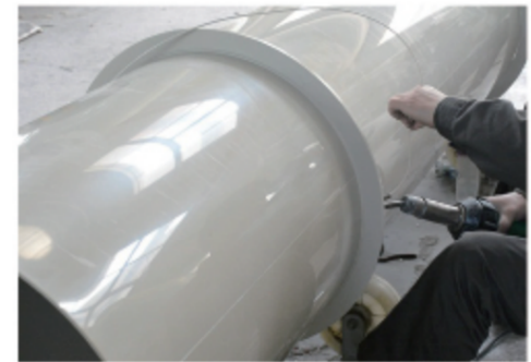
定制风管 材质：PP/PP阻燃/PVC 规格：圆形/方形，非标尺寸
