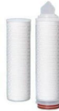
CAPP/CBPP系列微孔折叠滤芯由技术突破型亚微米级及高性能聚丙烯纤维膜材料制成，孔隙分布均匀，其中 CAPP经由科学结构设计使得滤芯具有高通量的特性，能够快速有效的帮助用户过滤料液中的颗粒杂质并优化经济成本。CBPP用高性能滤膜经由科学结构设计组合使得滤芯具有深层过滤，纳污量高的特点，在保证通量和效率的同时能够拦截更多的目标去除物，有效延长滤芯的使用寿命。
