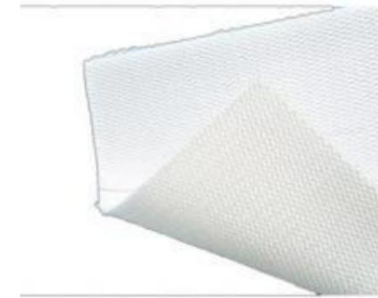
丙纶 (PP) 学名聚丙烯，以丙纶长丝织造而成的丙纶滤布具有很好的耐磨性，抗拉性，并且耐酸性，耐碱性以及耐腐蚀性都非常优秀。丙纶滤布表面光滑易卸料，可广泛应用于化工，医药，染料，矿物，冶金和污水等行业。
