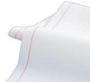
涤纶(PET)属于聚酯纤维，由涤纶长丝或短纤维织成的涤纶滤布具有良好的抗拉强度、耐磨性。耐氧化剂和还原剂的腐蚀，耐酸性均良好，但不适用于浓硫酸和磷酸。涤纶滤布的耐强碱性比较弱。
